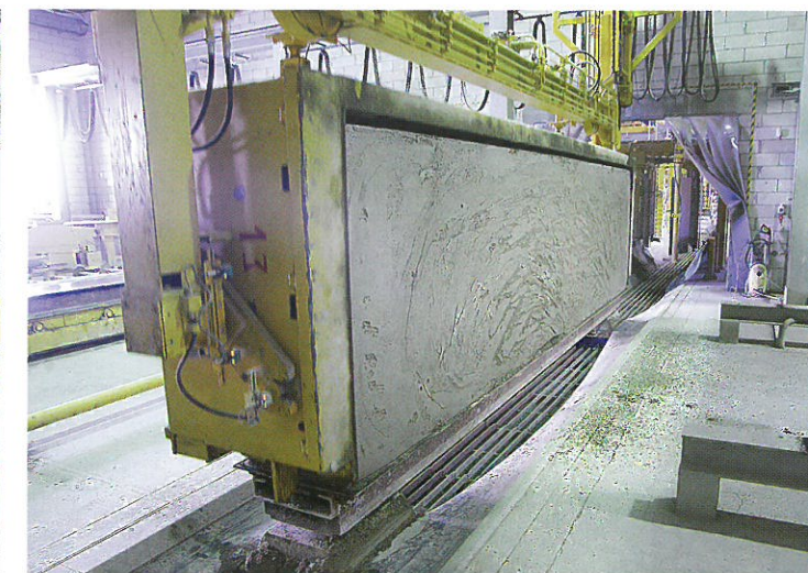
Põlevkivituhha, liiva ja vee segu on vormis tahenenud ning läheb edasi mõõtu lõikamisse.
