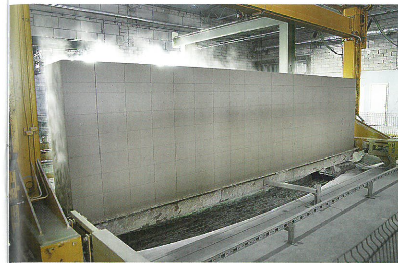
Massiiv on sobivatesse mõõtmetesse lõigatud ja läheb edasi autoklaavi.
